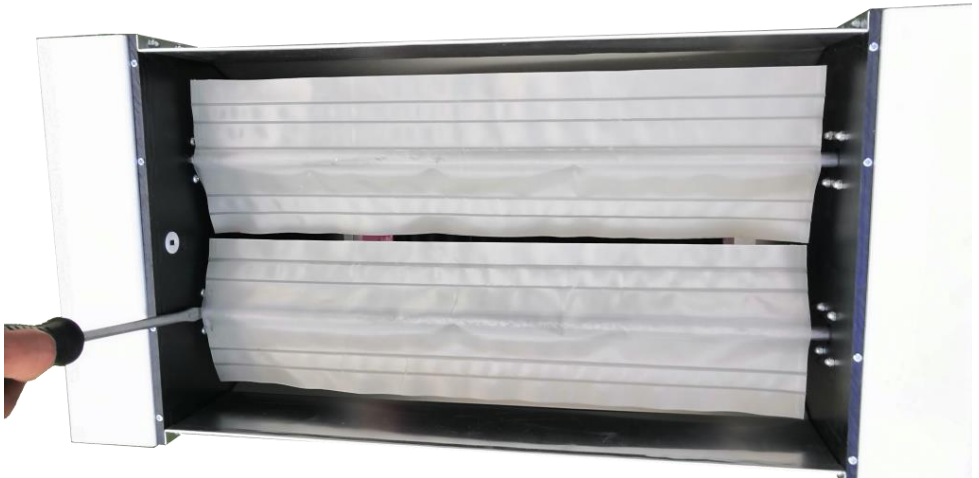
Bild 5 Austausch der Kehrfolie
