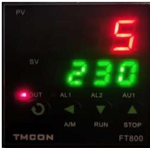
2. Um die Temperatureinstellung zu ändern, drücken Sie links die Einstelltaste "SET" und dann die oberen und unteren Pfeile, um den Wert auf die gewünschte Temperatur einzustellen.
